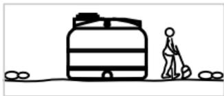
Prima di posizionare il serbatoio è necessario ripulire il luogo dell'installazione da eventuali detriti che possono danneggiarlo.
